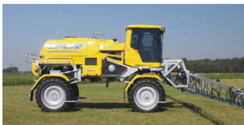
Fig.7: Pulverizadora automotriz (fertilizantes líquidos)
