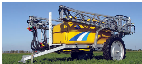
Fig. 8: Pulverizadora de arrastre (fertilizantes líquidos)
