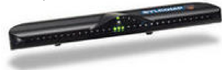
Fig. 1: Ejemplo de tablero de luces de Banderillero Satelital que indica al operador la dirección de trabajo. Cuando la dirección no es la correcta, las luces verdes del centro del tablero se mueven hacia uno de los lados del tablero indicando en qué sentido debe corregir el rumbo el operario.
