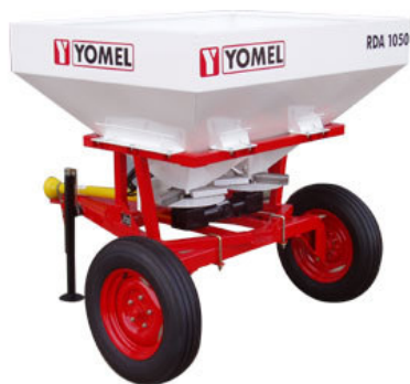
Fig. 5: Fertilizadora de Arrastre al Voleo (fertilizantes sólidos)
