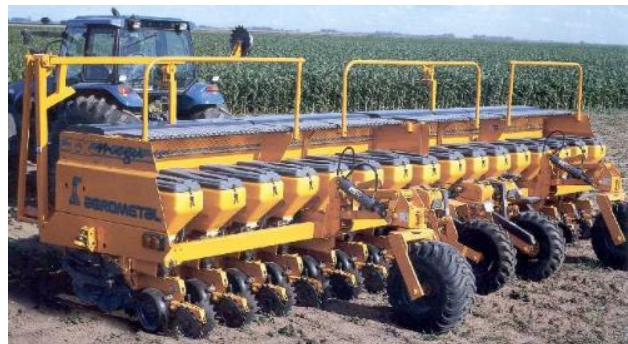
Fig.6: Sembradora con fertilización a dosis fija (fertilizantes sólidos).
